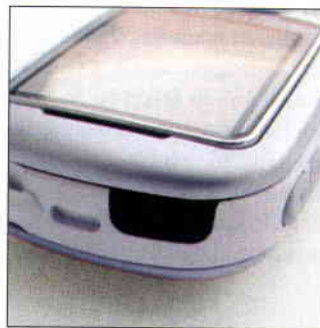
Kapcsolat. A készülék tetején foglal helyet az immár képküldést is lehetővé tevő infravörös port.
