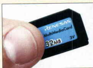
Memóriakártya. A készülék alsó részében megbújó, ujjhegynyi méretű RS MMC kártya 32MB-nyi adatot tud tárolni.
