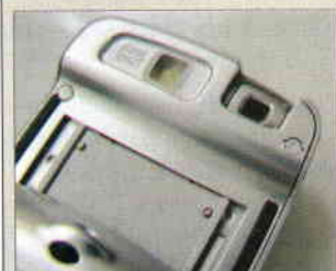
Kamera. Hátrafordított helyzetben a kamera csak a fedlap feltolása után tűnik elő. Az optika mellett kapott helyet a mobilfény.
