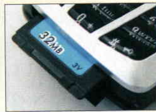
Memóriakártya. A készülék alsó részében megbújó, ujjhegynyi méretű RS MMC kártya 32MB-nyi adatot tud tárolni.
