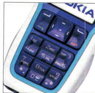
Billentyűzet. A készülék gombjai 3 kétsoros tömbbe rendeződve csoportosulnak.
